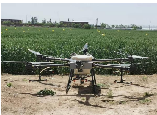
无人机一喷三防作业
