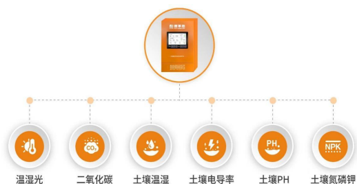
设施园艺数据自动采集平台
