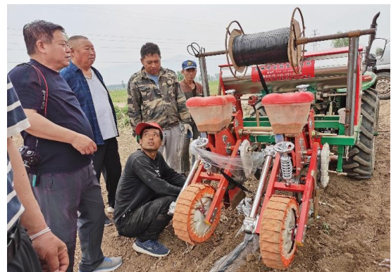
膜侧探墒沟播+膜下滴灌联合播种
